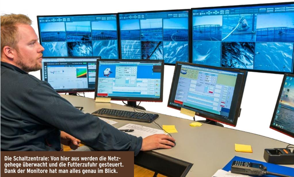
Die Schaltzentrale: Von hier aus werden die Netzgehege überwacht und die Futterzufuhr gesteuert. Dank der Monitore hat man alles genau im Blick.
